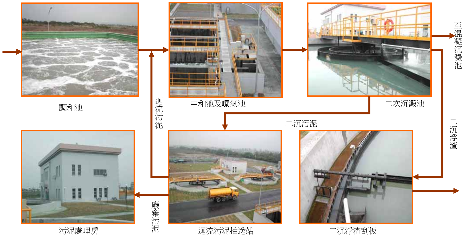
圖二 生物處理單元處理流程及設備
